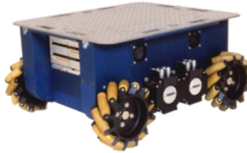
Figura 2.1: Robot holonómico con ruedas mecanum
