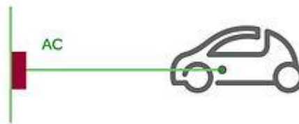
Figura 4: Modo de carga 1, enchufe no dedicado (IEC, 2016)
