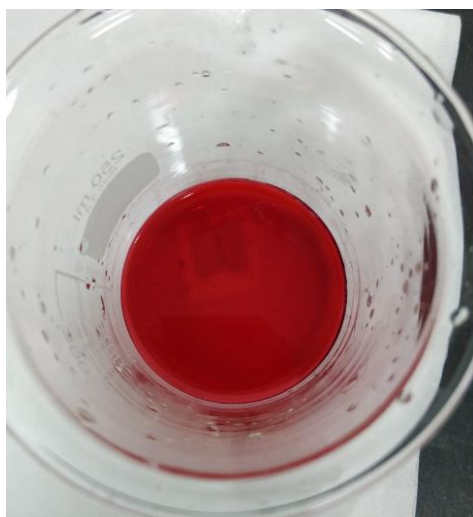
Figura 30. Electrodo sumergido en el tinte (Autoría propia).
