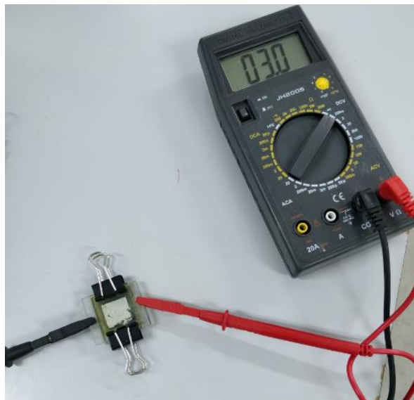
Figura 35 DSSC conectada al multímetro (Autoría propia).
