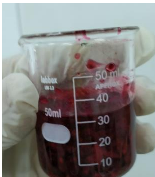
Figura 28. Mezcla de moras machacadas con HAc y etanol (Autoría propia).
