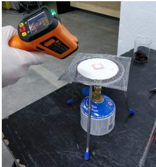
Figura 24. Electrodo siendo calentado sobre mechero Bunsen (Autoría propia).
