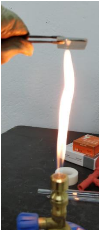
Figura 31 Cátodo siendo cubierto de hollín sobre un mechero Bunsen (Autoría propia).
