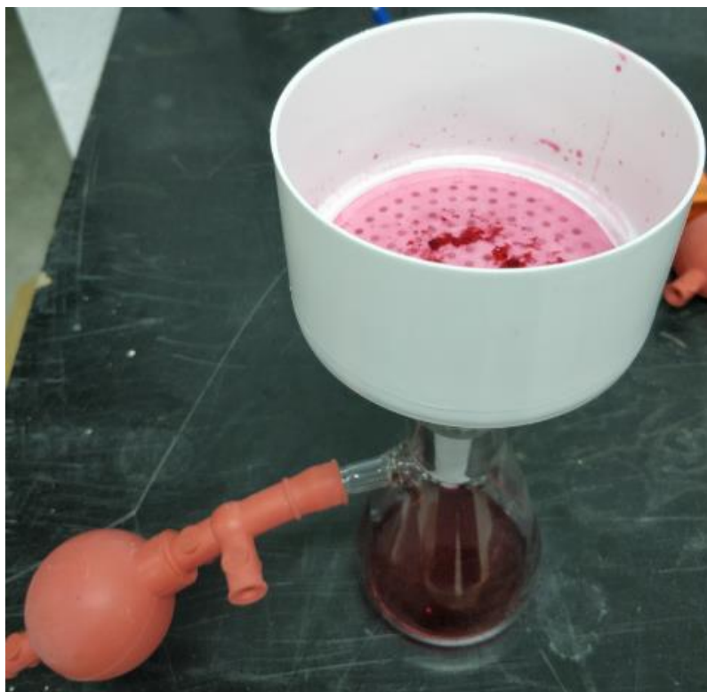
Figura 29. Extracción del tinte (Autoría propia).
