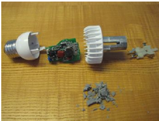
Figura. Lámpara de sustitución Cree LED BR30 flood light (equivalente a 65W) con detalle de su driver integrado
