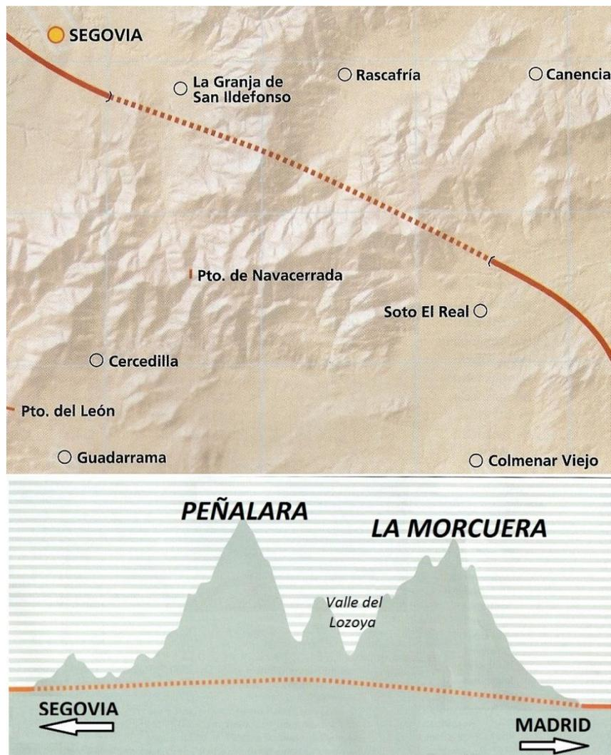
Fig.34. Planta y perfil del túnel de Guadarrama (Fuente, Vía Libre).
