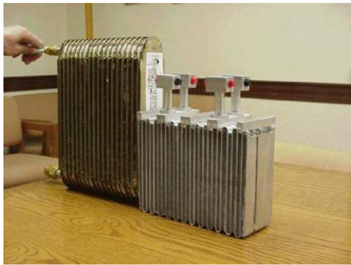
Figura 23: Evaporadores para automoción: convencional (izquierda) y de CO 2 (derecha)
