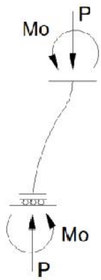
Figura 2.6 Soporte empotrado- Empotrado (deslizante)
