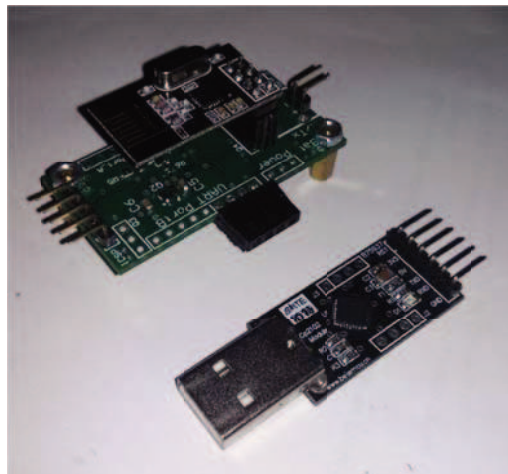
Ilustración 56 - Hardware listo para usar con módulo de comunicación nRF24L01
