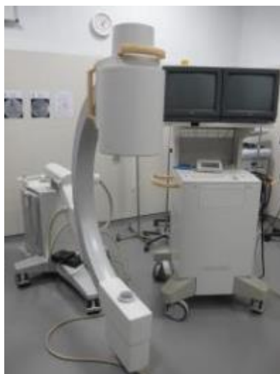
Figura 13. Arco digital en C (Philips Medical Systems BV Endura Modelo: MMM17AB) equipado con sustracción digital, road mapping, congelado de imágenes, toma de vídeo y posibilidad de toma de imágenes digitales directas o a través de vídeo.
