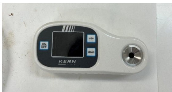
Figura 24. Medidor KERN Optics para determinar grados Brix.
