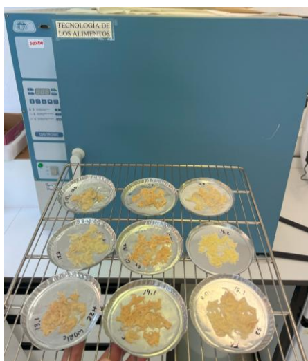
Figura 23. Secado de muestras de patata en estufa de aire caliente J.P. Selecta.
