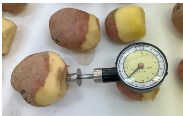
Figura 27. Penetrómetro manual FT-327 para determinar dureza de las muestras patata.
