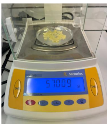
Figura 22. Báscula Sartorius CP 224 S para pesado muestras patata antes y después del secado.
