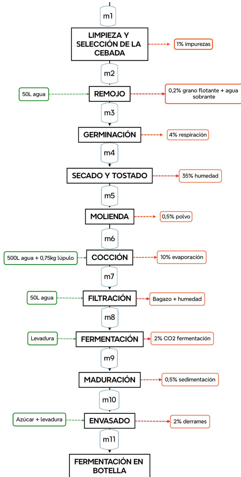
Figura 12. Diagrama de flujos de la agroindustria propuesta para un lote de producción.
