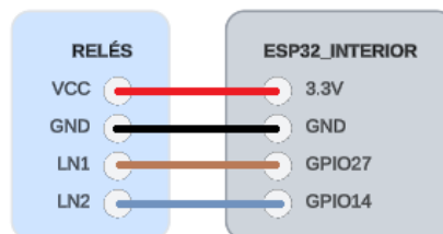
Figura 16 Conexionado módulo relé 3.3V 2CH
