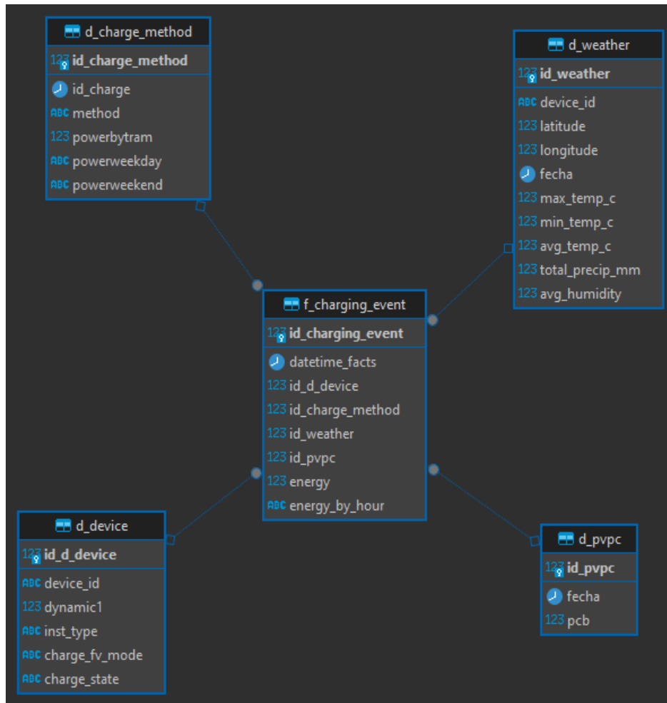
Figura 8: Diseño físico en PostgreSQL
