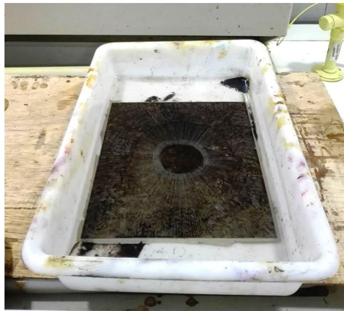
Plancha de zinc sumergida en ácido nítrico.
