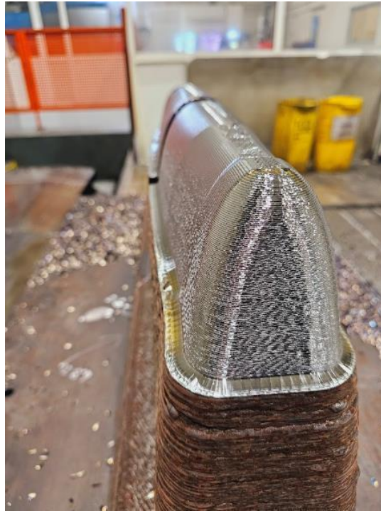
Ilustración 11 Construcción WAAM tras primera etapa de postprocesado
