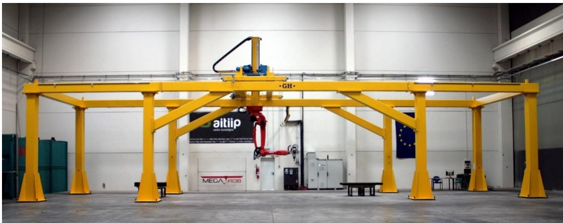
Ilustración 1 Sistema robotizado de fabricación híbrida KRAKEN. Fotografía tomada en las instalaciones de la Fundación Aitiip.
