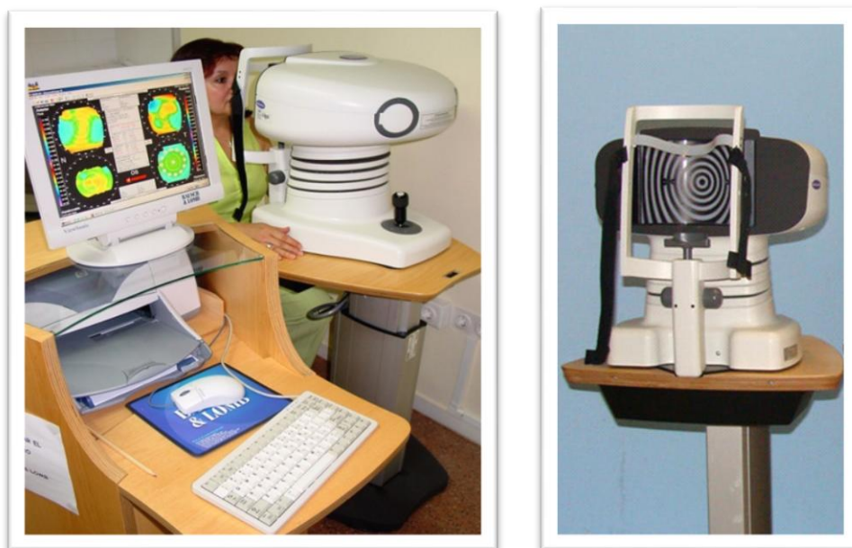
Figura 2: Imagen de un topógrafo Orbscan® IIz (Bausch and Lomb, Rochester, NY, Estados Unidos). A la derecha se aprecia el disco de Plácido.
