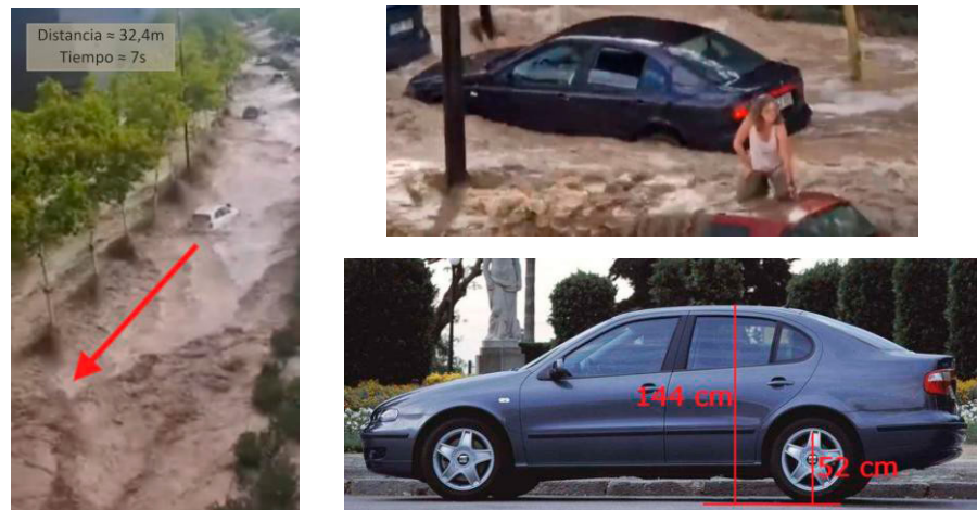
Figura 13 | Método para la estimación de la velocidad media del flujo durante el evento (izq.) y para la obtención del calado aproximado en la región aguas abajo del dominio mediante las dimensiones del vehículo SEAT Córdoba (der.).
