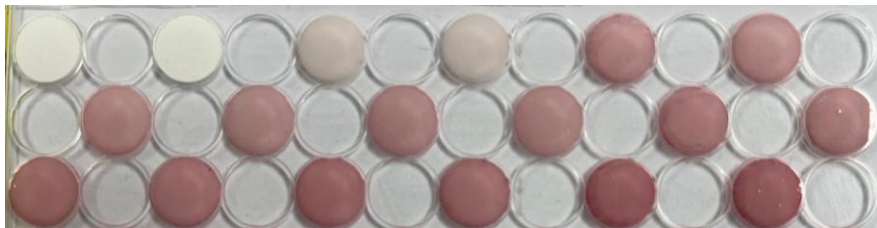
Figura 5.15: Fotografía de los sensores empleados para la calibración una vez transcurrida la reacción con escopolamina. Las concentraciones empleadas en las reacciones de la fotografía son, por parejas de izquierda a derecha y de arriba a abajo: Celulosas sin reaccionar, 0 , 6.00 \cdot 10^{-5} , 1.00 \cdot 10^{-4} , 3.00 \cdot 10^{-4} , 6.00 \cdot 10^{-4} , 1.00 \cdot 10^{-3} , 3.00 \cdot 10^{-3} y 6.00 \cdot 10^{-3} \text{ M} .
