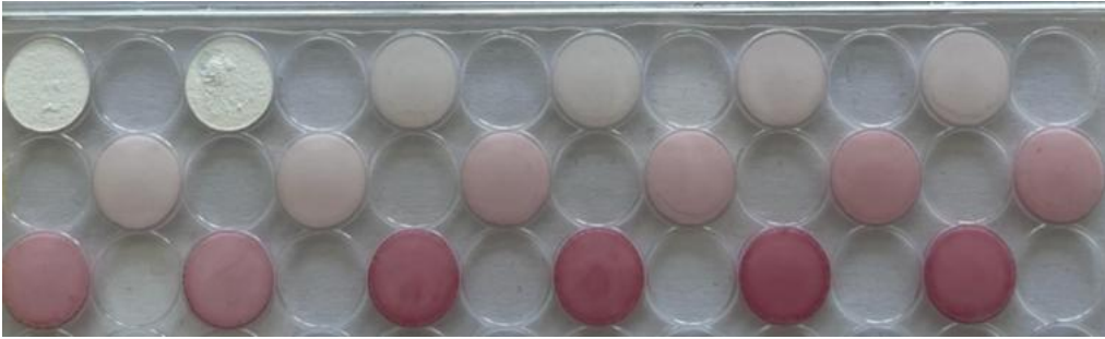
Figura 5.12: Fotografía de los sensores empleados para hacer la calibración una vez transcurrida la reacción. Las concentraciones de atropina empleadas en las reacciones de la fotografía son, por parejas de izquierda a derecha y de arriba a abajo: Celulosas sin reaccionar, 0, 6.00 \cdot 10^{-6} , 1.00 \cdot 10^{-5} , 3.00 \cdot 10^{-5} , 6.00 \cdot 10^{-5} , 1.00 \cdot 10^{-4} , 3.00 \cdot 10^{-4} y 6.00 \cdot 10^{-4} M.
