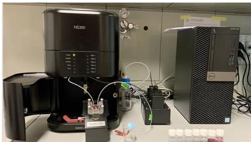
Figura A.7 Equipo Nanosight NS500. Obtenida de Instituto de Nanociencia y Materiales de Aragón (INMA) [9].
