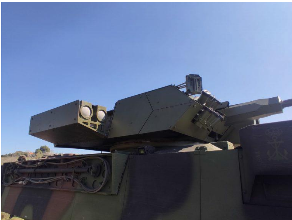
Ilustración 4. detalle del lanzador lateral para misiles Spike.
