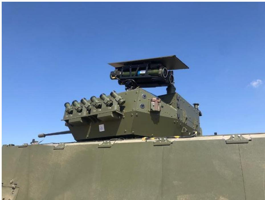
Ilustración 2: detalle de lanzador de misil Spike integrado en torreta "TOLEDO".
