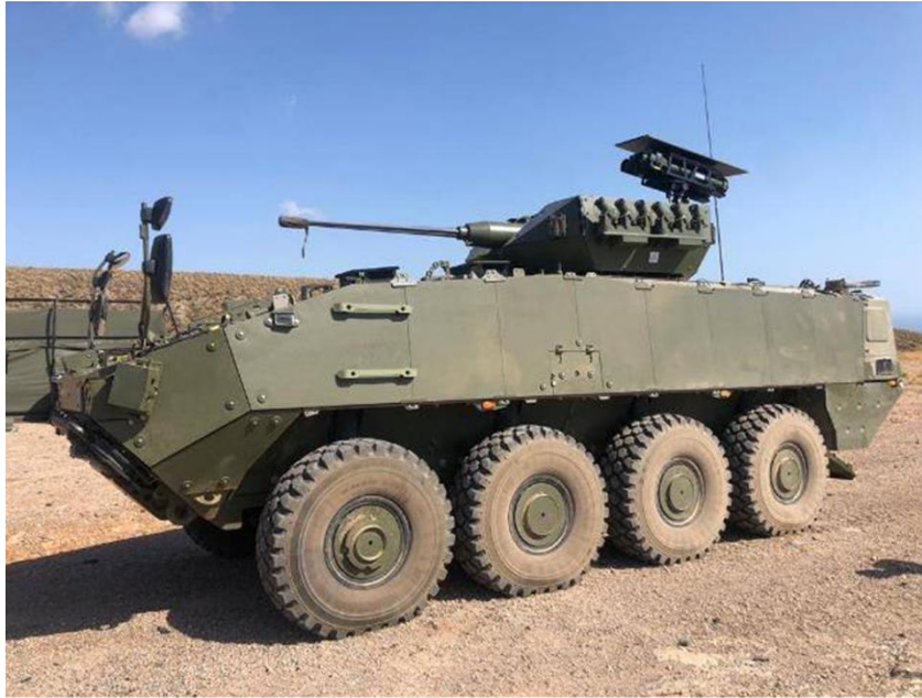
Ilustración 9: fotografía del demostrador número 2 de vehículo de combate sobre ruedas VCR en su versión VCI, artillado con la torre “Toledo” del tecnólogo Pap Tecnos, julio de 2020, Campo de Maniobras y Tiro “Álvarez de Sotomayor” (Almería)
