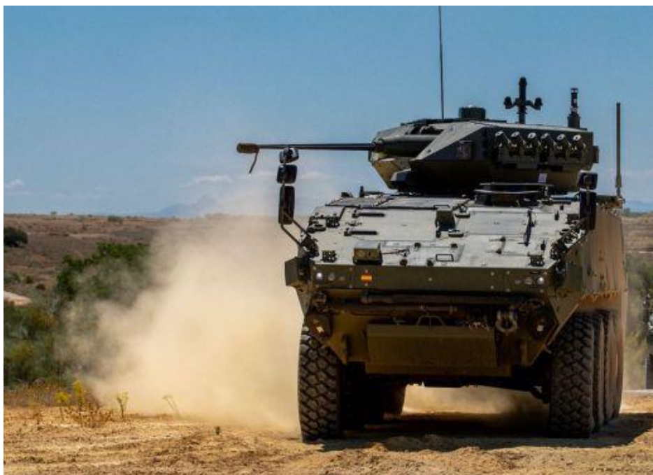
Ilustración 1: torreta “TOLEDO” de Pap Tecnos sobre demostrador número 2 de VCR 8x8 (2020).
