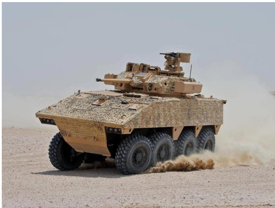
Ilustración 6: Vehículo de Combate 8x8 francés con torre y cañón CT40 (de Nexter)
