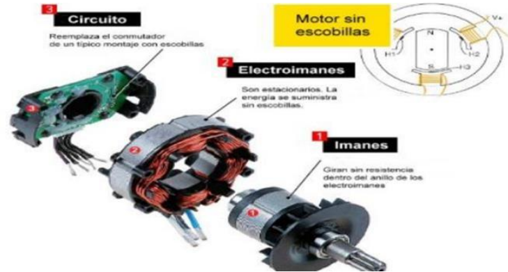
Ilustración 26: Esquema interno del Brushless
