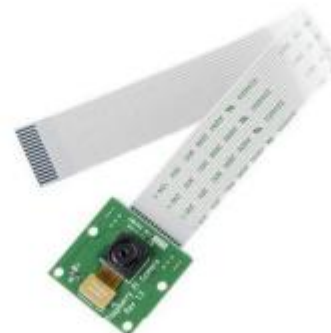
Figura 26 Cámara de la Raspberry
