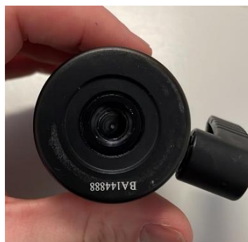
Figura 4. 34: Base con agujero roscado 3/8" BSW del soporte
