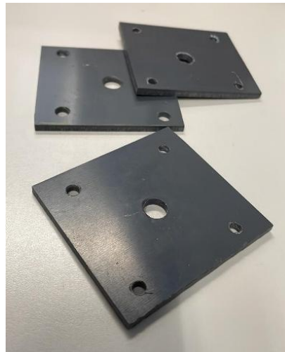
Figura 4. 32: Placas de PVC para aportar rigidez al apoyo de las cámaras en la estructura
