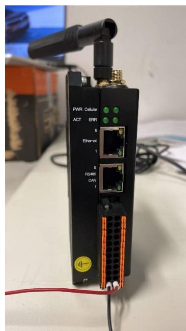
Figura 6. 1: Dispositivo ESP100 con base ESP32
