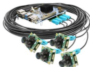
Figura 4. 28: Ejemplo de conexión de las cámaras mediante estos cables vía FPD-Link III
