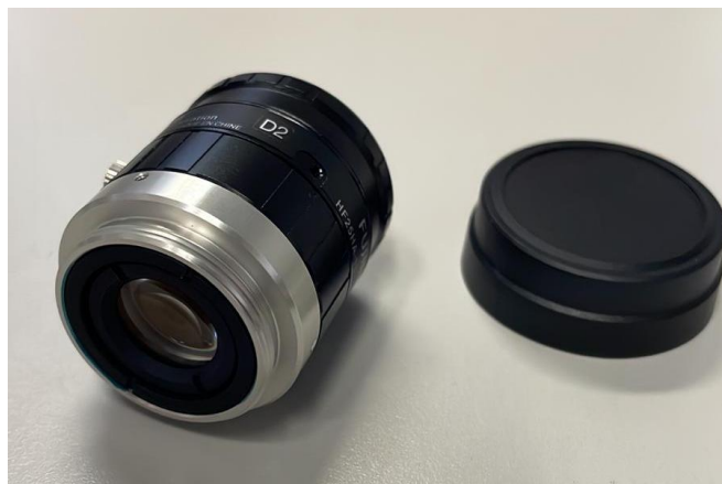
Figura 4. 17: Objetivos de la serie DF y HF calificados por distancia focal a) 6mm, b) 16 mm, c) 25 mm Fuente: Elaboración propia
