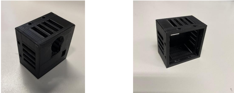
Figura 4. 31: Soportes para cámaras MIPI fabricados en PLA
