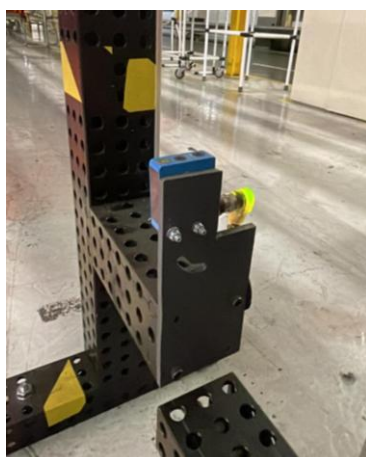
Figura 4. 21: Sensor SICK WL12L-2B530 situado en la parte derecha, encargado de disparar “trigger” las fotografías del vehículo mediante contadores
