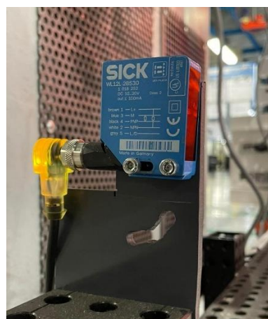
Figura 4. 21: Sensor SICK WL12L-2B530 situado en la parte derecha, encargado de disparar “trigger” las fotografías del vehículo mediante contadores
