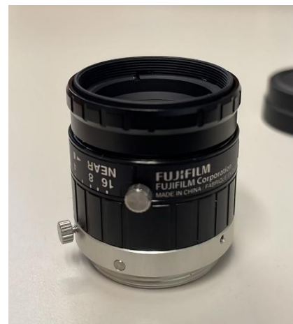
Figura 4. 18: Ejemplo de objetivo FJN-HF16HA-1S de distancia focal 16 mm
