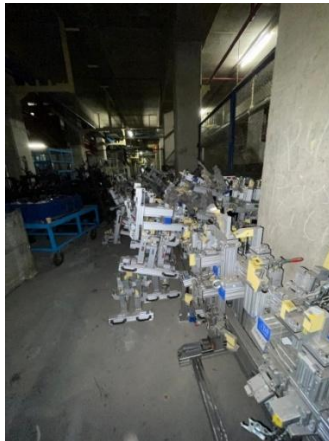
Figura 4. 40: imágenes del operativo de desmontaje de los perfiles ubicados en el sótano de prensas de la planta, para su posterior reutilización en las estaciones de visión
