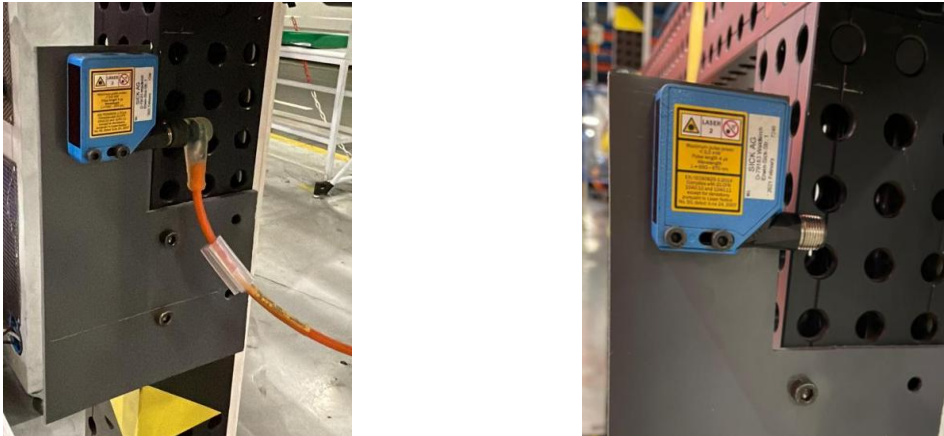
Figura 4. 22: Sensor SICK WL12L-2B530 situado en la parte izquierda, encargado de disparar para iniciar el ciclo de captura con la entrada de un coche a la estación
