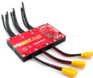
Ilustración 36 Controladora VESC HD75 (VESC, 2025)
