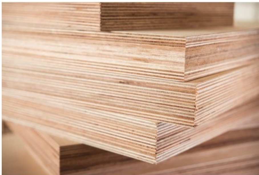
Figura 55. Tableros de contrachapado fenólico okume.
