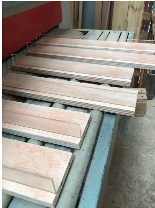
Figura 68. Encolado de el metacrilato en las ranuras de los laterales de las extensiones.
