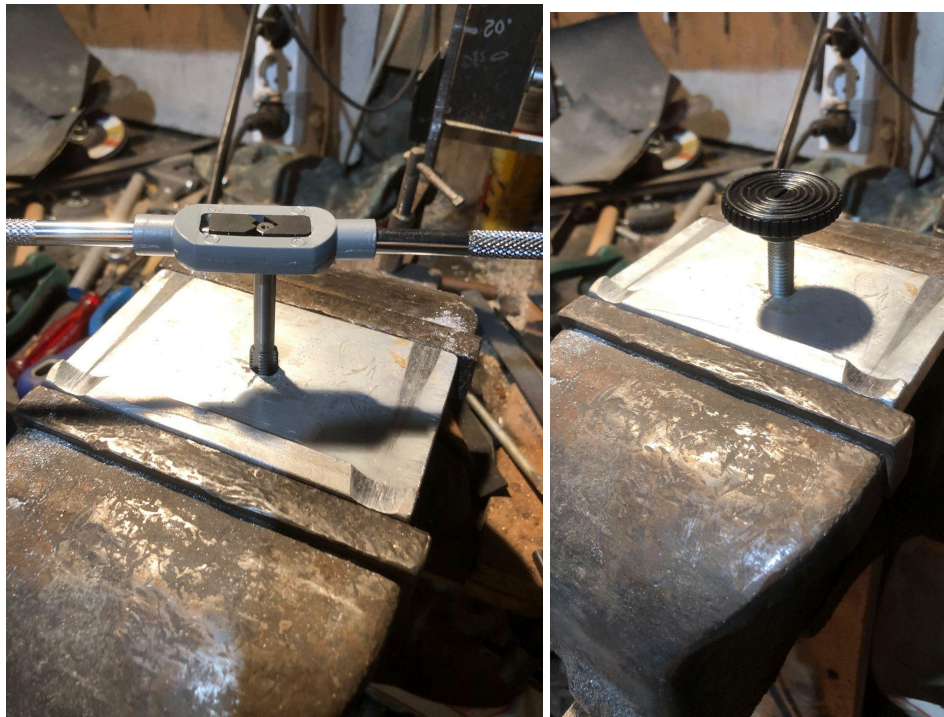
Figura 72. Roscado de la base para aportarle posibilidad de desplazamiento, este mecanismo no se ha incorporado al diseño final.
