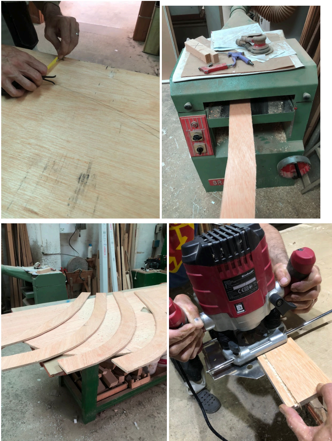
Figura 65. Corte, rebaje y ranurado laterales rampa.
