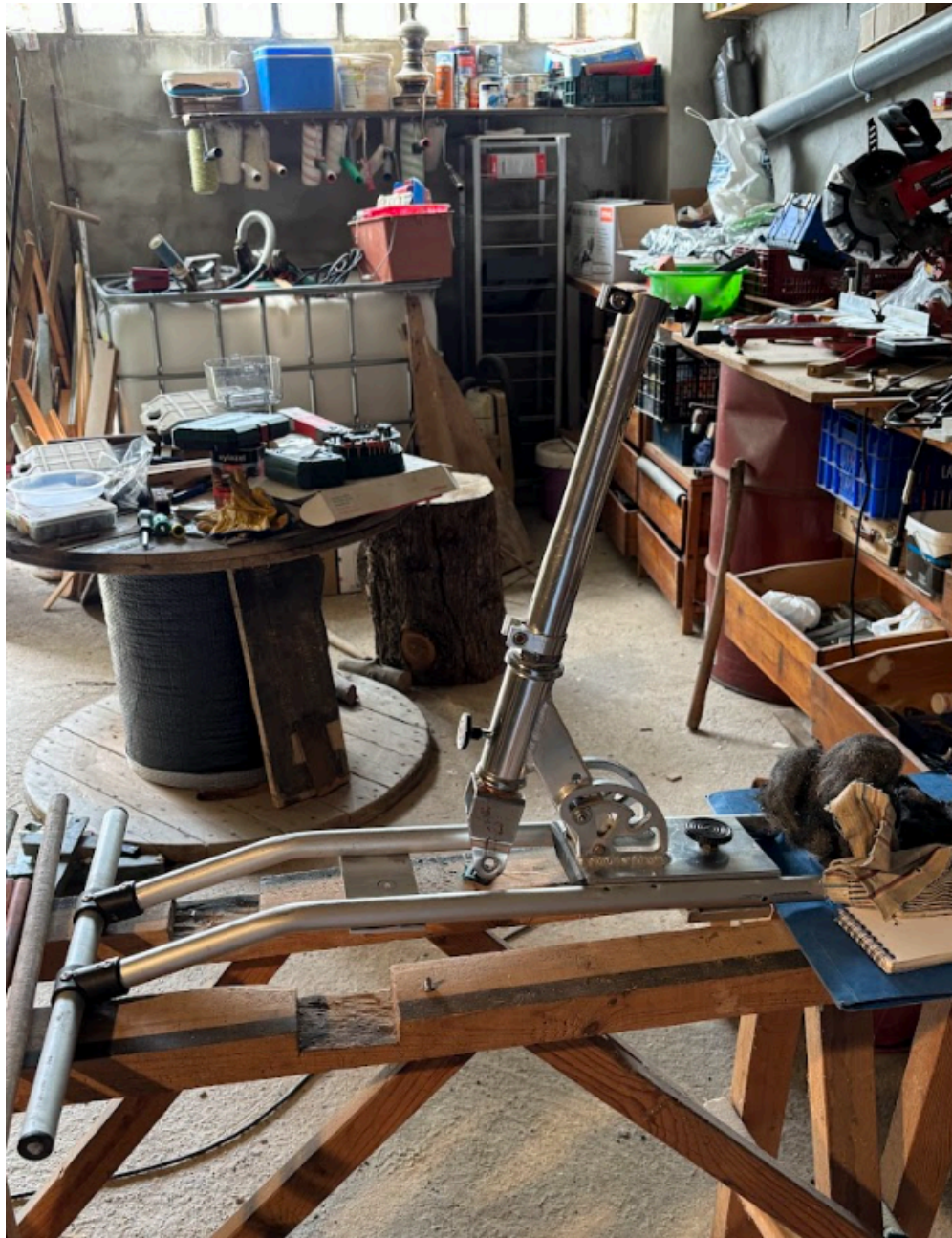
Figura 73. Mecanismo de fijación de la pierna extensible a la base, con rosado de tuba para introducir el pomo que permite el giro relativo.
