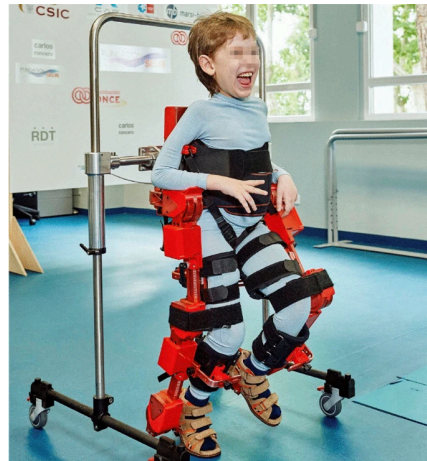
Figura 22. Exoesqueleto pediátrico de marcha de tipo THKAFO modelo ATLAS 2030.
