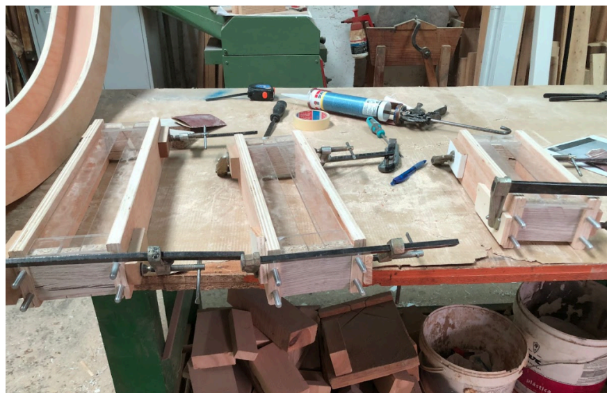
Figura 69. Ensamblaje de las extensiones, taladrado de todos los extremos (incluido el cuerpo de la rampa) e incorporación de tetones.
