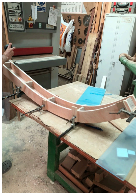
Figura 67. Ensamblaje de la rampa.
