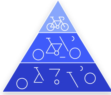
Figura B.4: Ejemplo de detección jerárquica de patrones en una CNN [IBM24]. En la base de la pirámide se detectan características de bajo nivel (ruedas, manillar), que se combinan progresivamente para reconocer objetos de alto nivel como una bicicleta completa.
