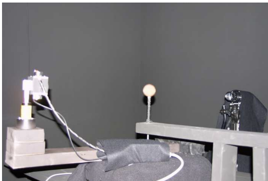
(a) Foto del gonio-reflectómetro usado para medir BRDFs de MERL [Mat+03].
