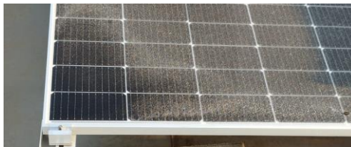
Ilustración 7 Módulo con suciedad (Enerland)
