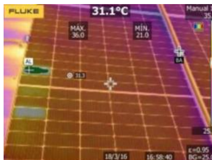
Ilustración 9 Termografía del módulo (Enerland)
