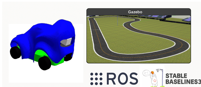
Figura 1.2: Este esquema ilustra los componentes principales del sistema desarrollado, incluyendo el entorno de simulación (Gazebo), el entorno (Gymnasium) y el agente de RL (Stable Baselines3).
