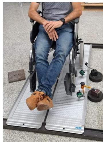
Figuras 34 y 35: Ensayos en rampa de material compuesto a la izquierda y de aluminio a la derecha.
