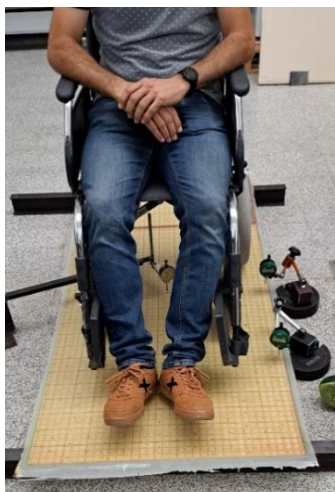
Figuras 34 y 35: Ensayos en rampa de material compuesto a la izquierda y de aluminio a la derecha.
