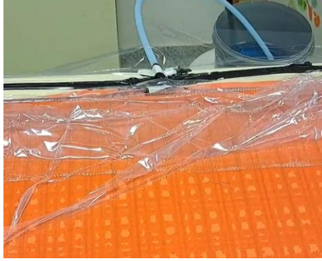
Figura 28: Resina infusionando en el molde.
