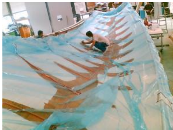
Figura 1: Uso de materiales compuestos laminados en la industria naval.
