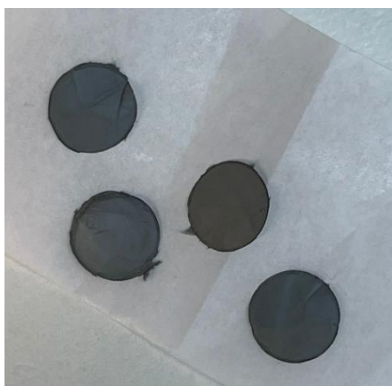
Figura 10 - Cuatro de los seis discos de NFMs de 13mm usados en la degradación
