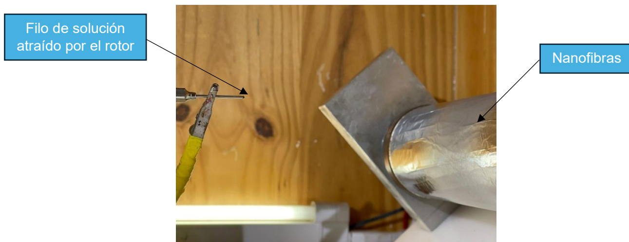
Figura 6 - El material de la jeringuilla siendo atraído por el rotor para fabricar las nanofibras debido a la diferencia de potencial
