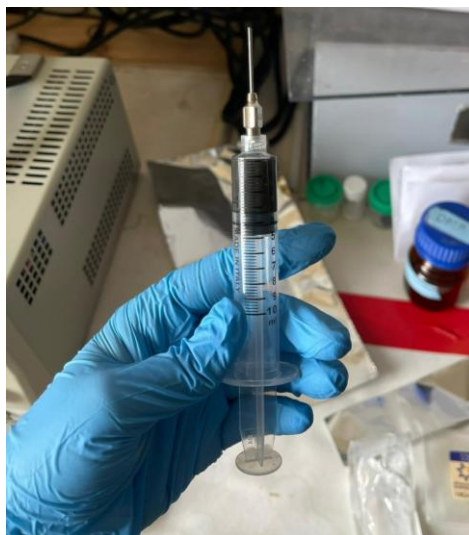
Figura 4 - Jeringuilla conteniendo la solución a electrohilar (PAN+NPs+DMF)
