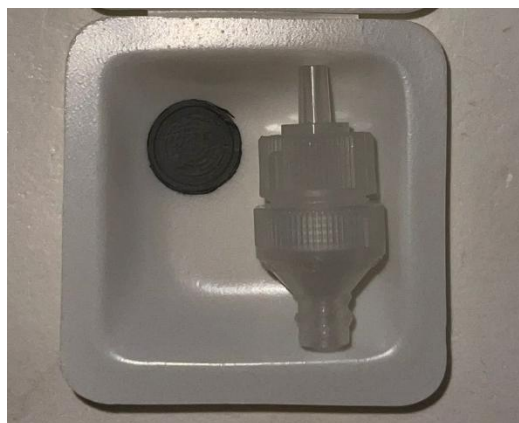
Figura 11 - Portafiltros empleado junto a los discos de nanofibras compactados
