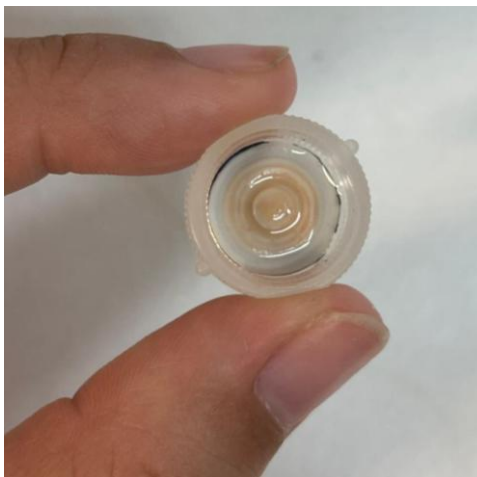
Figura 24 - Discos de fibras en el portafiltros tras el tratamiento con campo magnético
