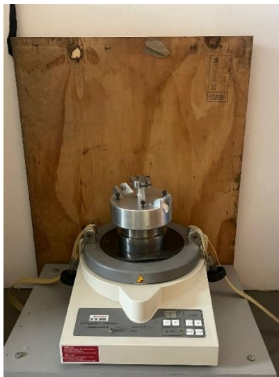
Figura 2 - Máquina para proceder con la molienda mecánica de la pirita
