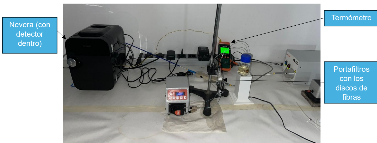
Figura 29 - Montaje para la degradación de la rifampicina con los discos de las NFMs
