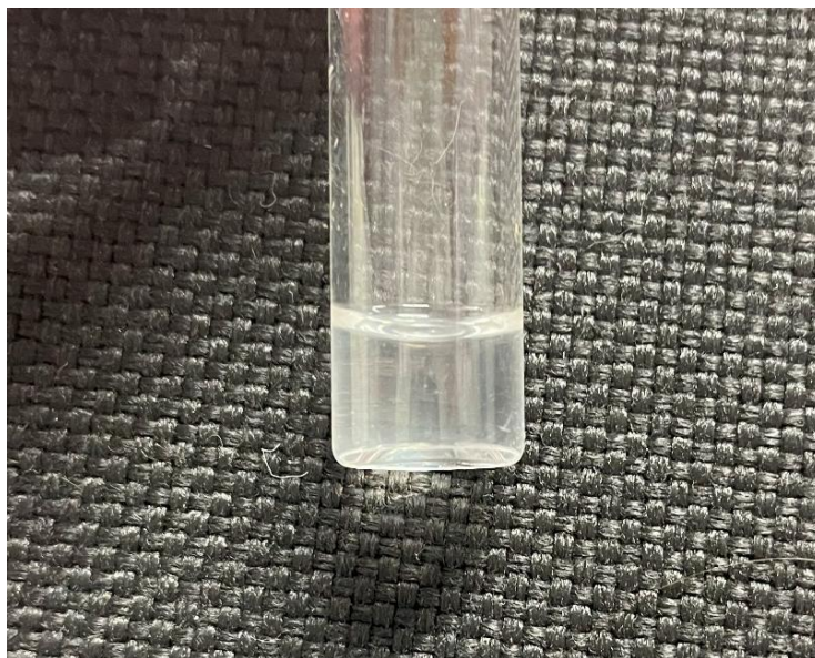
Figura 8. Suspensión bacteriana homogénea con concentración de 10^6 - 10^7 UFC/100 mL en tubo de ensayo.
