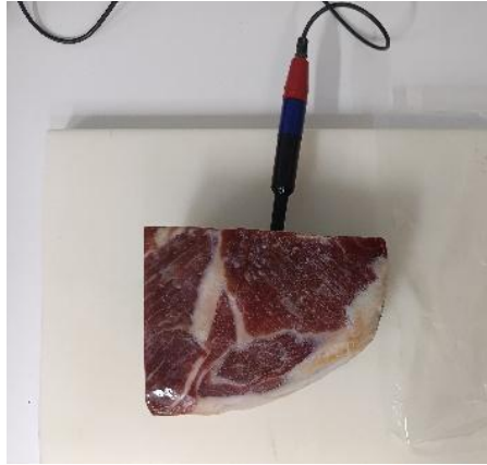
Figura 10. Procedimiento de medida de pH en cada una de las muestras.
