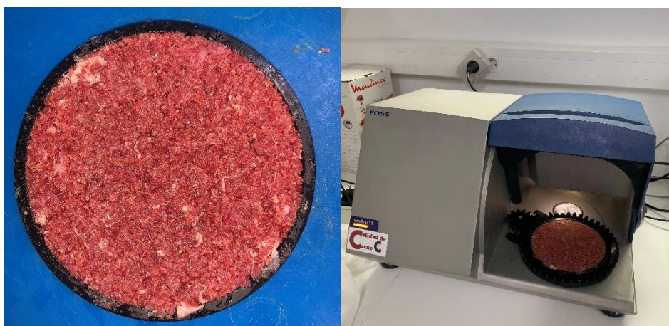
Figura 9. Imagen de la muestra una vez triturada y de cómo se coloca en el equipo NIR para realizar el análisis.
