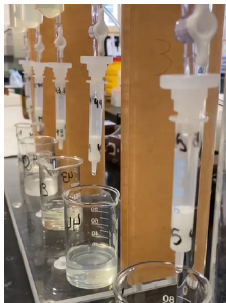
Figura 5. Fotografía de muestras pasando por la columna a una velocidad de 1-2 gotas por segundo.
