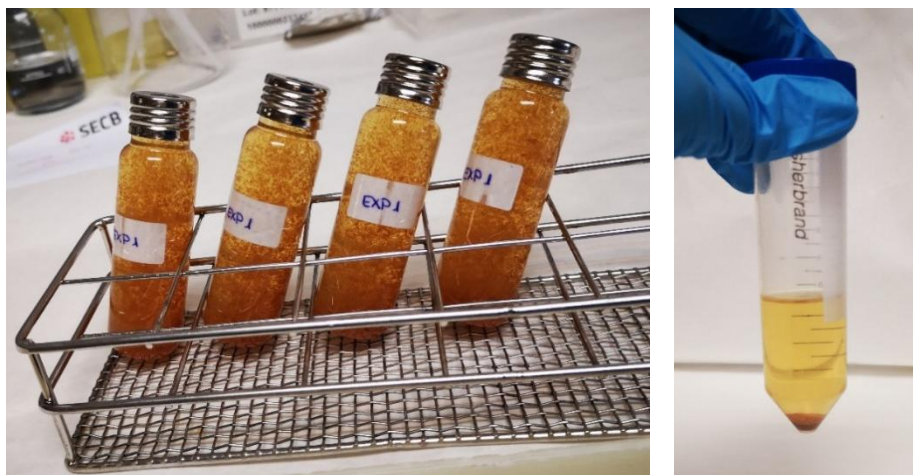
Figura 4. Muestras con partículas en suspensión (a, izquierda) y tras el centrifugado (b, derecha).
