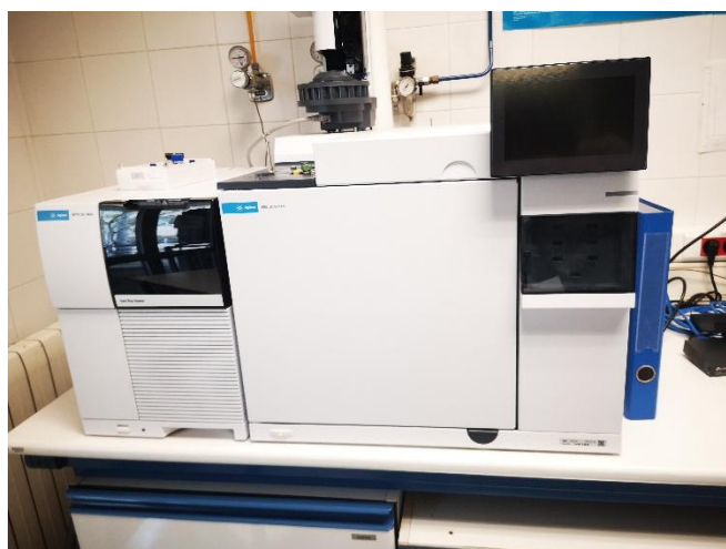
Figura 3. Cromatógrafo de gases-masas (8890 GC de Agilent).
