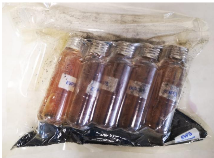
Figura 2. Doble embolsado con carbón activo de los viales.
