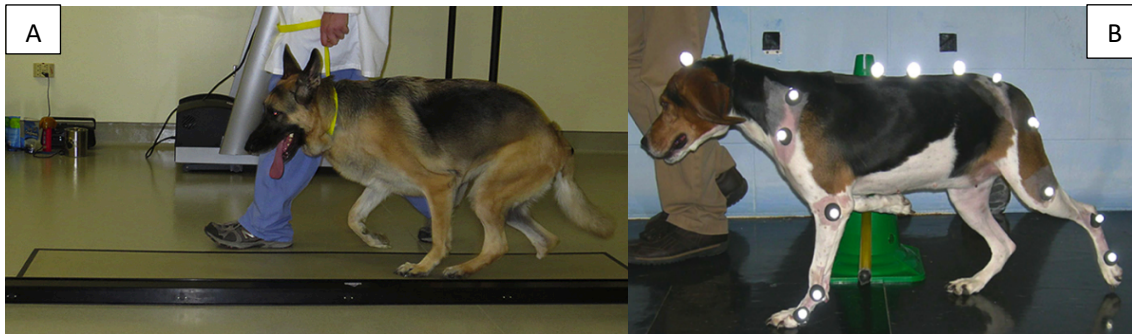
Figura 5. A. Plataforma de fuerza. B. Sensores en la piel (Millis y Ciuperca, 2015)
