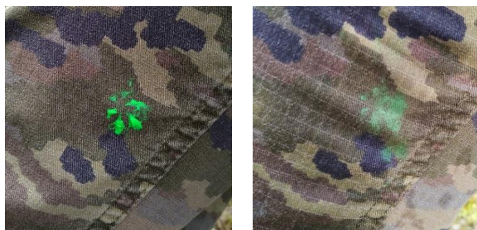
Figura 2.9 y 2.10 Impacto sobre uniforme del ET (izquierda) y su resultado tras frotar ligeramente con agua (derecha) (Fuente: Elaboración propia)
