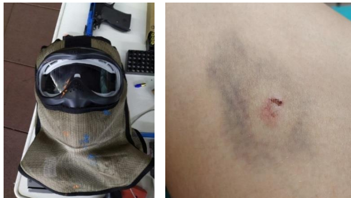
Figura 2.24 y 2.25 Resultado del impacto de la munición sobre máscara de protección (izquierda) y sobre piel con ausencia de protección por debajo de la distancia de seguridad recomendada(derecha) (Fuente: Elaboración propia)
