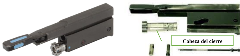
Figuras 2.21 y 2.22. Cierre SIMUNITION (izquierda) frente a cierre original del fusil HK G36 (Fuente: www.aasias.com y Manual Técnico HK G36 del MADOC)
