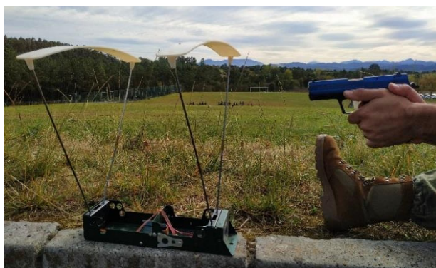
Figura 2.13 Prueba con cronógrafo balístico. Pistola HK USP Standard y munición SIMUNITION 9mm Parabellum. (Fuente: Elaboración propia)
