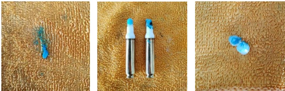
Figuras 2.14, 2.15 y 2.16 Proyectil FX 5.56 x 45mm sometido a -5°C (izquierda) y tras prueba de calor a +45°C (centro y derecha) (Fuente: Elaboración propia)
