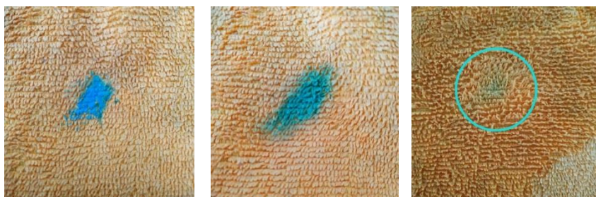
Figuras 2.6, 2.7 y 2.8 Mancha de pigmento (izquierda), tras frotado (centro) y tras aclarado (derecha) (Fuente: Elaboración propia)
