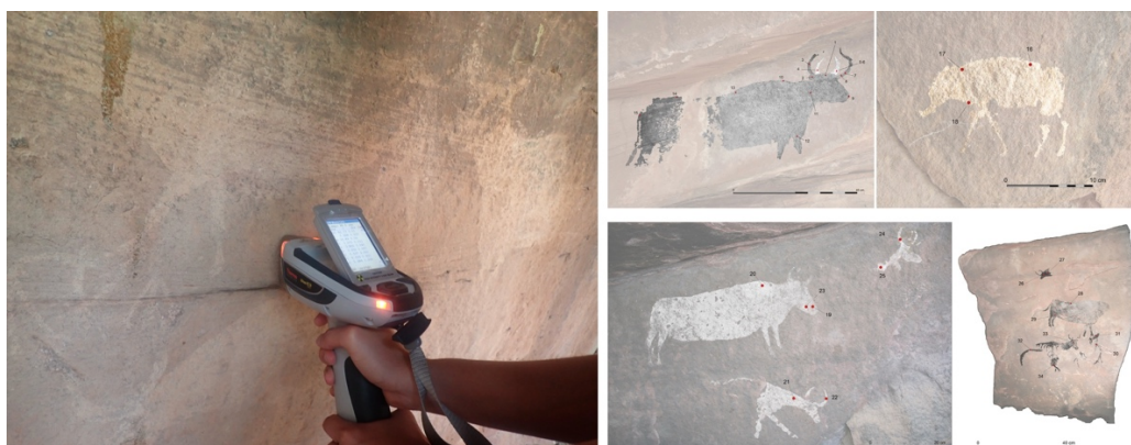
Fluorescencia de Rayos X portátil para conocer materiales compositivos de los motivos pintados.
