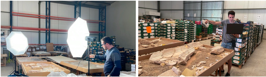
Láser escáner 3D aplicado a los elementos en estuco y fotogrametría realizada sobre los fragmentos pictóricos (realizado por proyecto DiGHER y SeGAP de Unizar).
