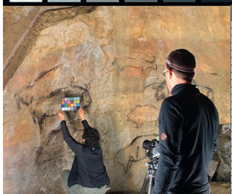
Figure 3: Système utilisé pour corriger la température de couleur à l'aide d'une charte d'étalonnage calibrée.
