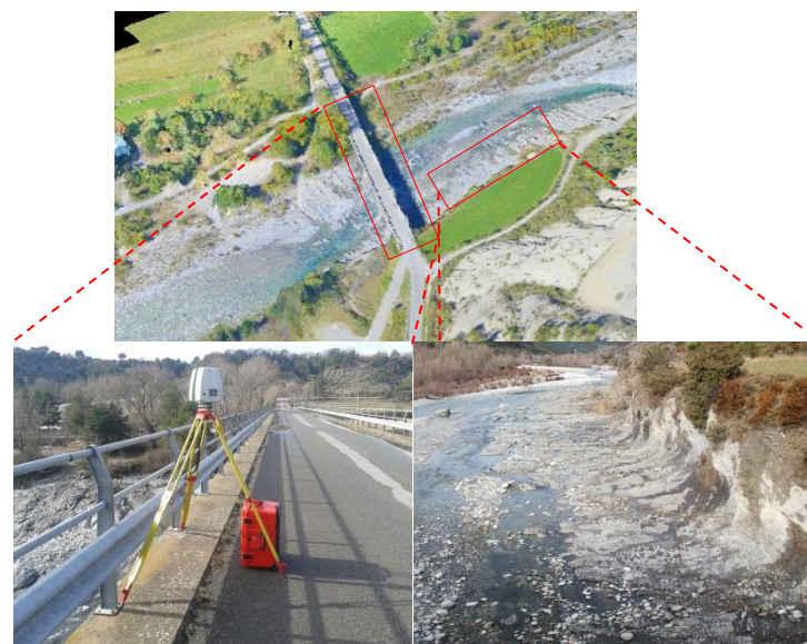
A.3. Escaneo de 2 tipos de superficie según su rugosidad: (i) lisa (izquierda, puente) y (ii) rugosa (derecha, lecho en roca con bolos)
