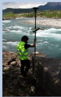
B.1: Localización de 220 puntos de control distribuidos por el tramo de 13km. (distribución siguiendo criterios Vericat et al., 2009 ) Coste: 2 personas/2 días- 220 GCPs con 2 GPS diferencial Leica VIVA@ GS15 en RTK (Real Time Kinematic).
