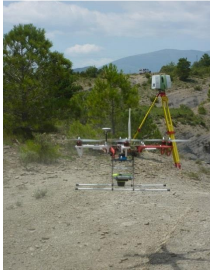
Figura 3. Láser Escáner Terrestre y UAV tomando datos en una zona de cárcavas del pirineo aragonés. En el caso del UAV se puede observar la cámara ubicada en la parte inferior. La cámara captura fotografías de manera automática a una frecuencia de 5s. Estas fotografías se utilizan para la obtención de información topográfica mediante la aproximación de SfM. La calidad de los modelos se compara con la información obtenida con TLS (foto tomada por Smith & Vericat -verano 2013- en el marco de BadlandScan II; zona de badlands en la proximidades del Pueyo de Araguás; alto Cinca)
