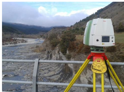
A.1. 2 Estacionamientos del Laser Escáner Terrestre, modelo ScanStation C10 de Leica Resolución: 2cm a 50metros
