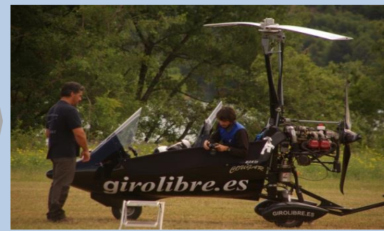
B.2: Obtención de fotografías aéreas (cámara Nikon 3100 @) usando un autogiro biplaza tripulado. Coste: 1hora/4 pasadas de vuelo/1800 imágenes.
