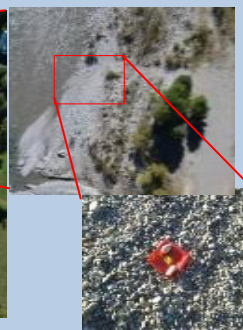
B.1: Localización de 220 puntos de control distribuidos por el tramo de 13km. (distribución siguiendo criterios Vericat et al., 2009 ) Coste: 2 personas/2 días- 220 GCPs con 2 GPS diferencial Leica VIVA@ GS15 en RTK (Real Time Kinematic).
