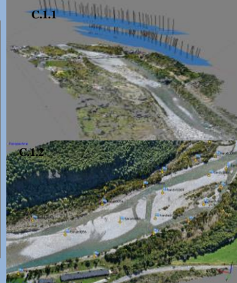
Figura 19. Flujo de trabajo para la obtención de modelos topográficos del cauce seco mediante fotografía digital automatizada (SfM).
