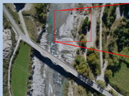
B.1: Localización de 220 puntos de control distribuidos por el tramo de 13km. (distribución siguiendo criterios Vericat et al., 2009 ) Coste: 2 personas/2 días- 220 GCPs con 2 GPS diferencial Leica VIVA@ GS15 en RTK (Real Time Kinematic).
