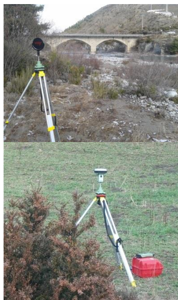
A.2.1. Posicionamiento de 3 dianas para la orientación del TLS y posterior georreferenciación en coordenadas globales
