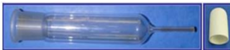
Fig. B.11. Sistema de recogida de hollín. Portafiltros (Izqda.) y filtro (Dcha.)
