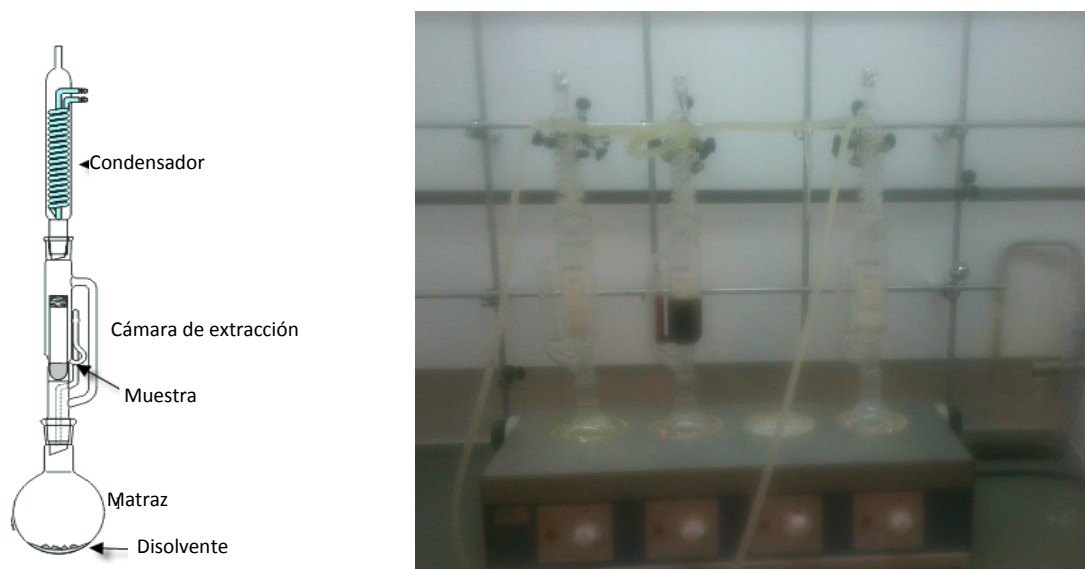
Fig. B.17. Esquema (Izqda.) e imagen (Dcha.) de la extracción Soxhlet.
