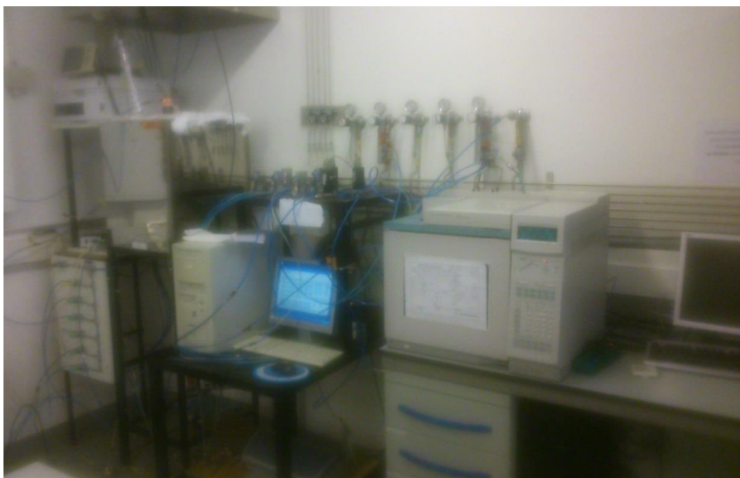
Fig. 3.2. Fotografía del sistema experimental para la formación y recogida de PAH y hollín.
