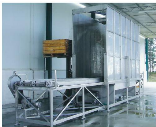
Figura 62. Drencher (Metálicas Sánchez Romero)
