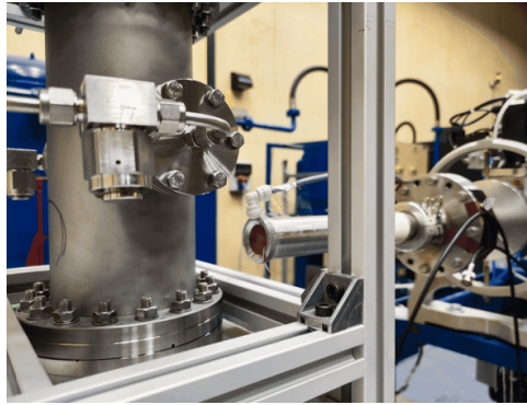
Figura 6: Montaje para la irradiación: la vasija de acero en una estructura de aluminio, con la fuente de neutrones apuntando a la zona que contiene el CaO en polvo [2].
