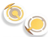
Figura 7. Imagen de una microbalanza de cristal de cuarzo (QCM) adaptada de Inficon. 16
