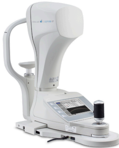
Figura 4: Dispositivo Corvis ST empleado en este estudio para la medida de las propiedades biomecánicas de la córnea [25].
