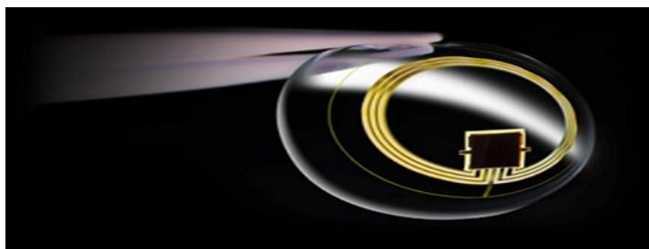
Figura 2: Sensor de lentes de contacto Triggerfish® (Sensimed AG).
