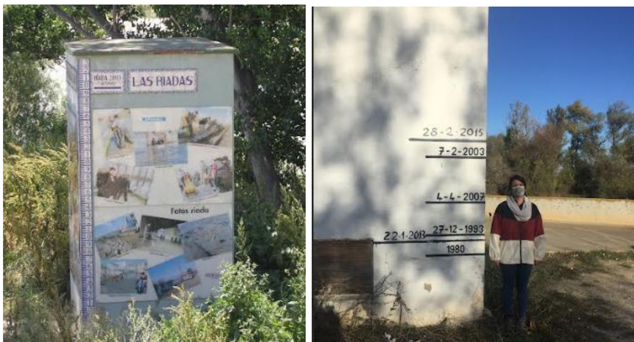
Fotos 2 y 3. Limnimarcas de Pradilla de Ebro (izq.) y Boquiñeni (dcha.). Fuente: Alfredo Ollero.
