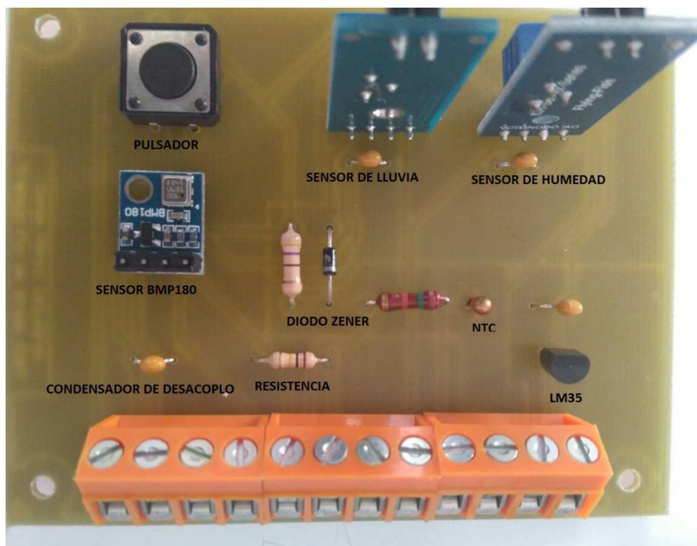
Figura 28: Componentes de la placa de circuito impreso de los sensores.
