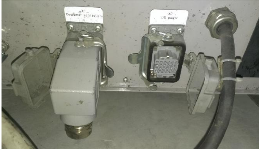
Ilustración 3 Conectores personalizados y anulador de seguridad.
