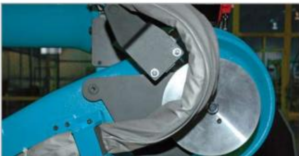
Figura 23 Sistemas limitadores de la zona de trabajo para los ejes 1, 2 y 3.
