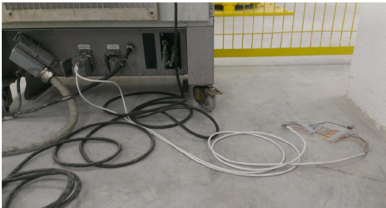
Ilustración 6 Conexión del XC a las regletas añadir/quitar puentes.
