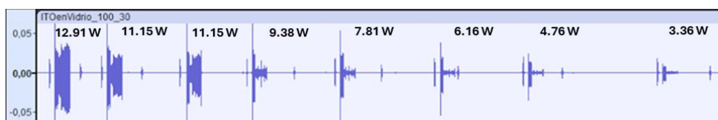
Figura 16. Señales acústicas registradas durante tratamientos sobre ITO depositado en vidrio con valores de potencia por encima de 2.16 W.
