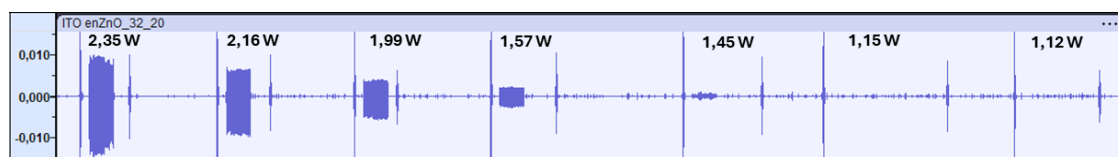
Figura 30. Señales acústicas registradas durante los tratamientos realizados sobre ITO depositado en ZnO.
