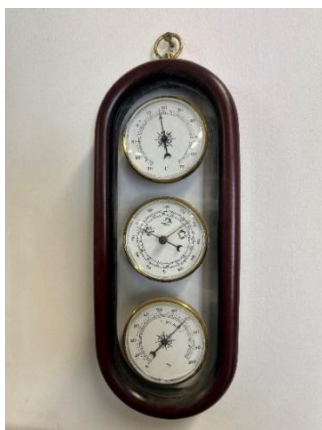
Figura 2. Estación de medida de presión y temperatura.
