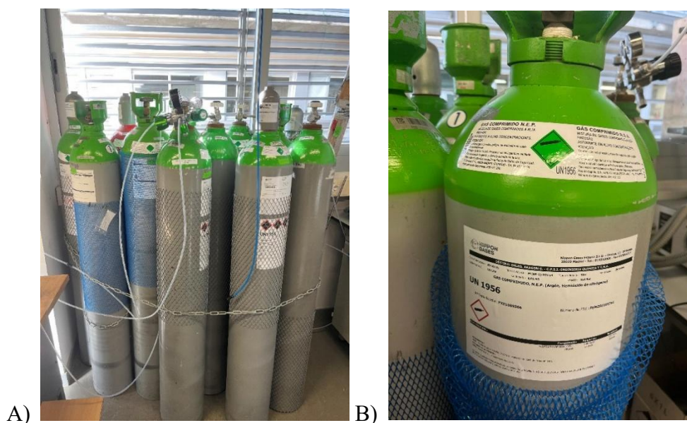
Figura 3. A) Botellas presurizadas en el laboratorio. B) Etiqueta de la botella de óxido nítrico.
