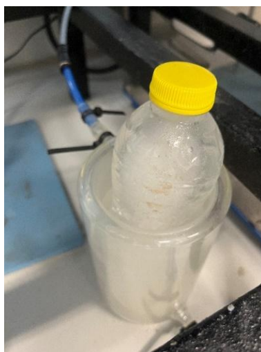
Figura 12. Condensador a la salida del reactor.
